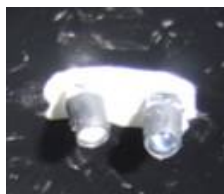
Ilustração 5: Detalhe do isolamento dos emissores e receptores.
