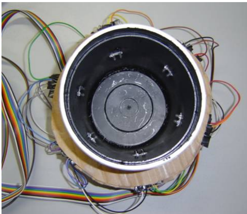
Ilustração 8: Pintura final em preto, para evitar reflexão.
