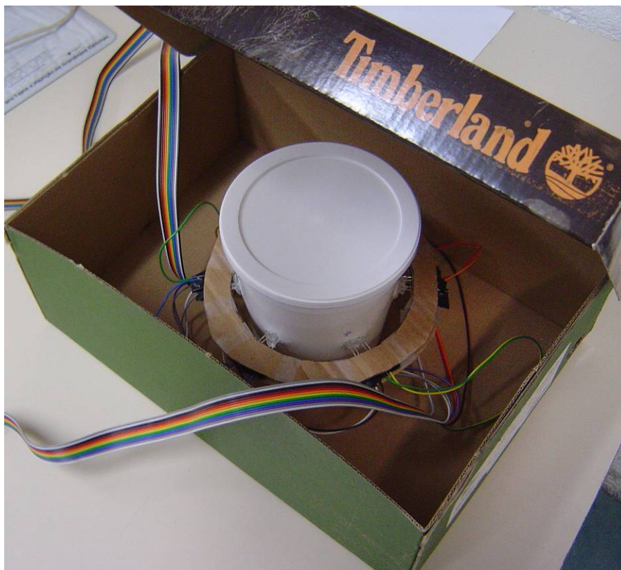
Ilustração 7: Isolamento óptico do protótipo.
